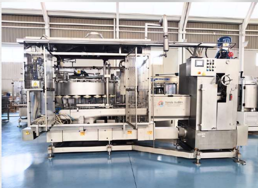
SERTISSEUSE AUTOMATIQUE ANGELUS AVEC GROUPE DE REMPLEISSAGE SOUS VIDE ZILLI & BELLINI À 36 VALVES
