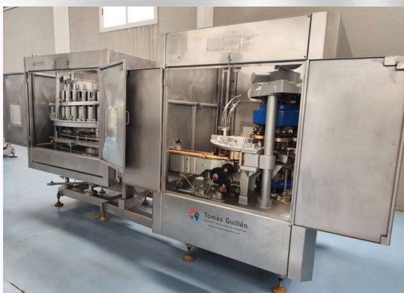
SERTISSEUSE AUTOMATIQUE DE BOÎTES ANGELUS 40P AVEC GROUPE DE REMPLISSAGE À 21 PISTONS FMC
