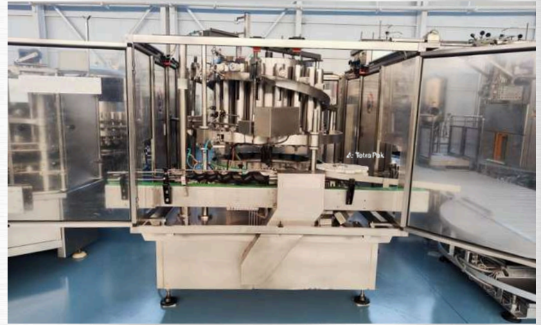
ZILLI & BELLINI آلة تعبئة ذات 18 مكبس من
