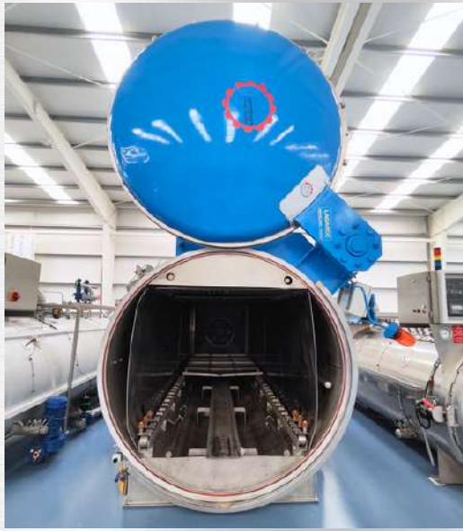
جهاز تعقيم ثابت LAGARDE 4 سلال
