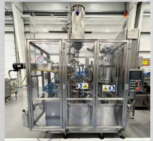
آلة تعبئة وتغليف الأكياس FLEXTECH GUALAPACK CHIP30-RS
