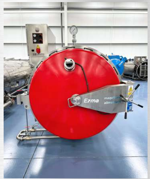
جهاز تعقيم ثابت EZMA 6 سلال
