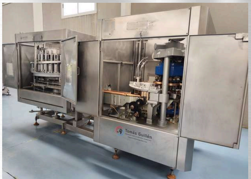
مع ANGELUS 40P آلة إغلاق علب أوتوماتيكية مجموعة تعبئة مكونة من 21 مكبس FMC
