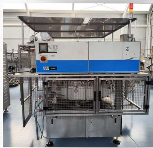
آلة تعبئة وتغليف الأكياس البلاستيكية بالفراغ TOYO JIDOKI TVP-E3
