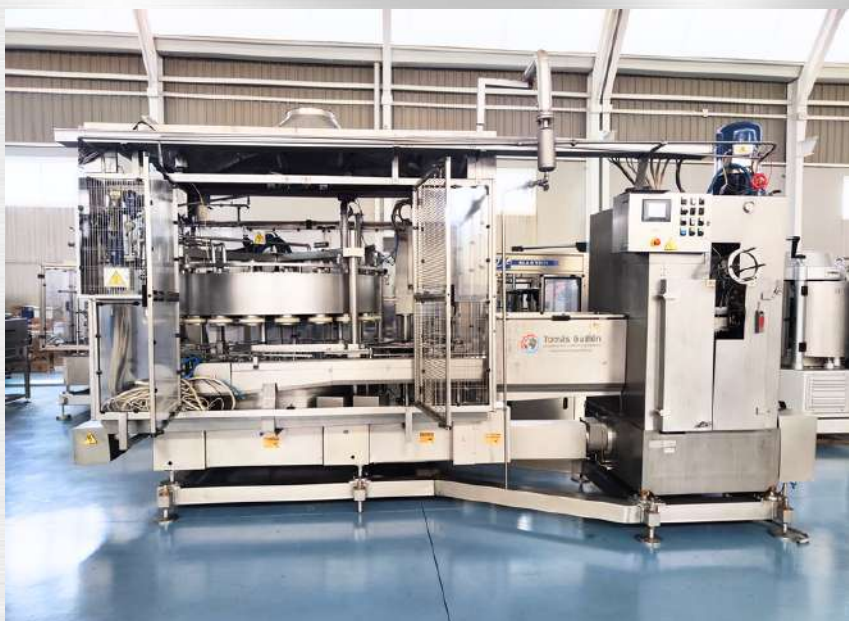
CERRADORA AUTOMÁTICA DE LATAS ANGELUS CON GRUPO BAJO VACÍO ZILLI & BELLINI DE 36 VÁLVULAS
