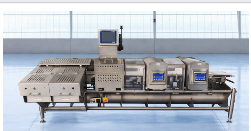
METAL DETECTOR DOPPIO SAFELINE CON SISTEMA DI CONTROLLO DI PESO METTLER TOLEDO
